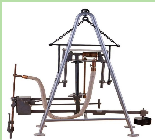
Электрический плавильник конструкции Николая Славянова, 1891 год
